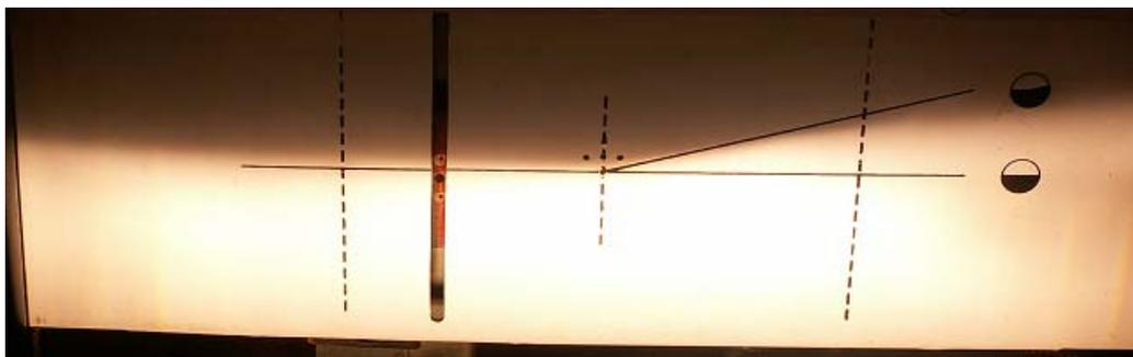
**Exemple de ligne de coupure du faisceau en dessous du repère correspondant à un rabattement de -2,5% pour un feu situé à une hauteur (h) inférieure à 80 cm**
