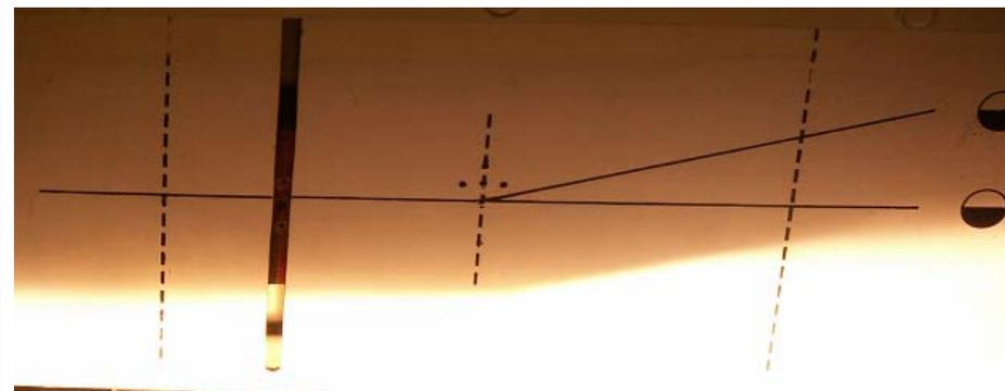
**Exemple de ligne de coupure du faisceau au dessus du repère correspondant à un rabattement de -0,5% pour un feu situé à une hauteur (h) inférieure à 80 cm (Eblouissement)**
